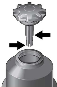
Das Servolenkungsöl muss zwischen dem oberen Bund und dem unteren Ende des Messstabs stehen.
