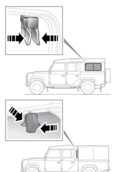
Den Verriegelungsmechanismus zusammendrücken und das Fenster in die gewünschte Stellung schieben. Den Verriegelungsmechanismus loslassen und darauf achten, dass er in eine Vertiefung zum Feststellen des Fensters eingreift.
