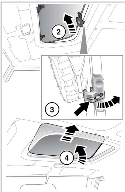
1. Zum Öffnen des Schiebedachs das Handrad im Uhrzeigersinn und zum Schließen gegen den Uhrzeigersinn drehen.
