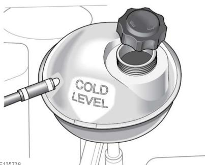
Bei deutlich abgefallenem Füllstand ist von einem Leck oder von Überhitzung auszugehen und das Fahrzeug von einem qualifizierten Techniker untersuchen zu lassen.
