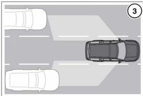
Система контроля "мертвых зон" (BSM) контролирует участки в непосредственной близости от автомобиля, которые не видны водителю. Система предназначена для обнаружения других участников дорожного движения, которые обгоняют ваш автомобиль (3) и находятся в "мертвой зоне", игнорируя неподвижные или двигающиеся в противоположном направлении объекты.
