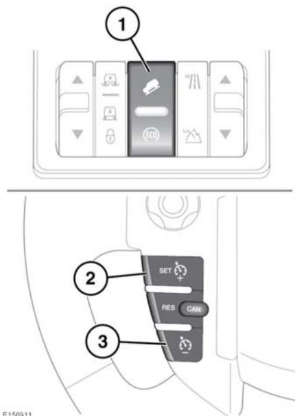
Систему HDC можно использовать в режимах (D), (R) или на **первой** передаче CommandShift в верхнем диапазоне и в режимах (D), (R) и на любой передаче CommandShift в нижнем диапазоне. Когда коробка передач переведена в режим D, автоматически выбирается наиболее подходящая передача.
