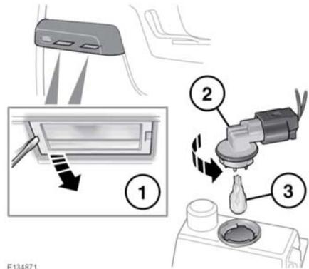
Die abgebildeten Schritte befolgen. Eine neue Glühlampe einsetzen und die Komponenten wieder einbauen.
