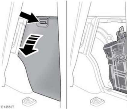
**7-Sitzer:** Der Werkzeugsatz befindet sich hinter einer Zugangsabdeckung im Laderaumbereich.
