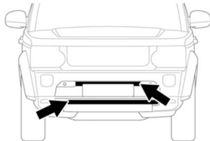
Mit einem Schlauch sauberes Wasser durch den vorderen Stoßfänger spritzen (siehe Abbildung), um Schlamm an Kühler und Klimaanlage Kondensator zu entfernen.
