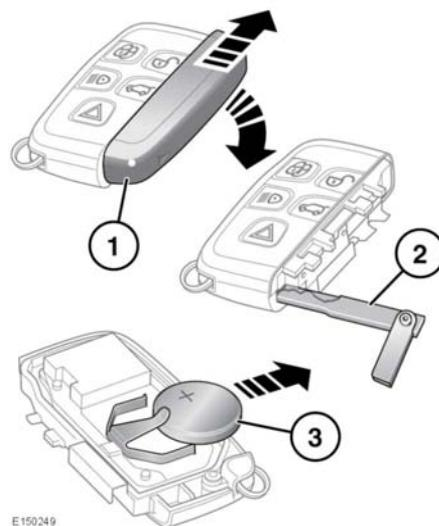
Per sostituire la batteria:
