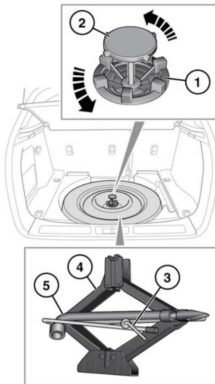
1. Anello di bloccaggio della ruota di scorta.
