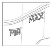
Sicherstellen, dass der Kühlmittelstand zwischen den beiden Markierungen **MIN** und **MAX** an der Seite des Ausgleichsbehälters bleibt.
