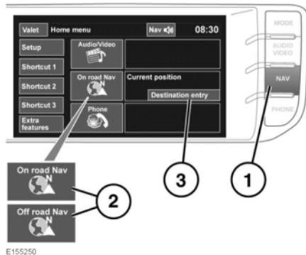
1. Аппаратная клавиша **NAV**: нажмите для входа в навигационную систему.
