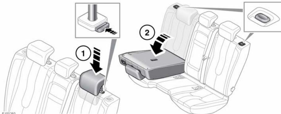
La banquette arrière rabattable des modèles 5 portes se replie complètement ou partiellement (60/40) pour offrir un plus grand espace de chargement tout en conservant des sièges pour les passagers.
