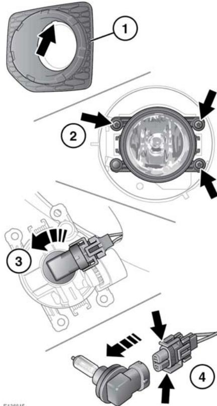
1. Passez le doigt dans la fente située au sommet de l'encadrement du phare et faites levier avec un outil adapté pour le déposer.
