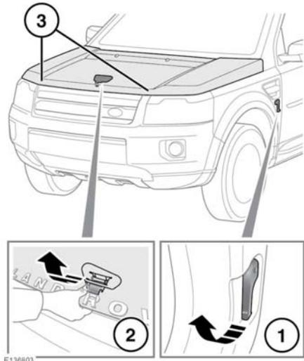
1. Tirez le levier d'ouverture du capot situé dans le plancher avant gauche.
