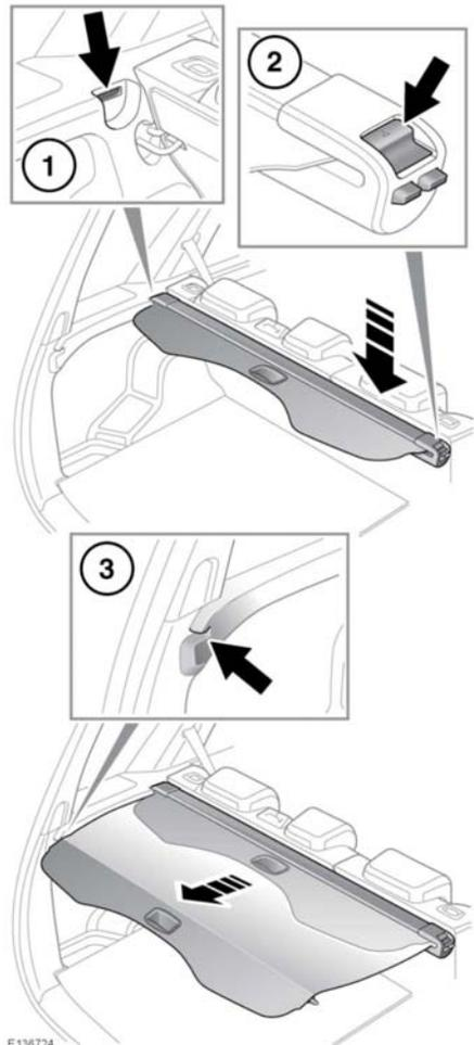
1. Установите монтажный штифт на левом конце крышки багажного отделения в паз.
