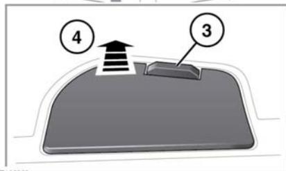
1. Нажмите на фиксаторы, чтобы снять крышку с корпуса.
