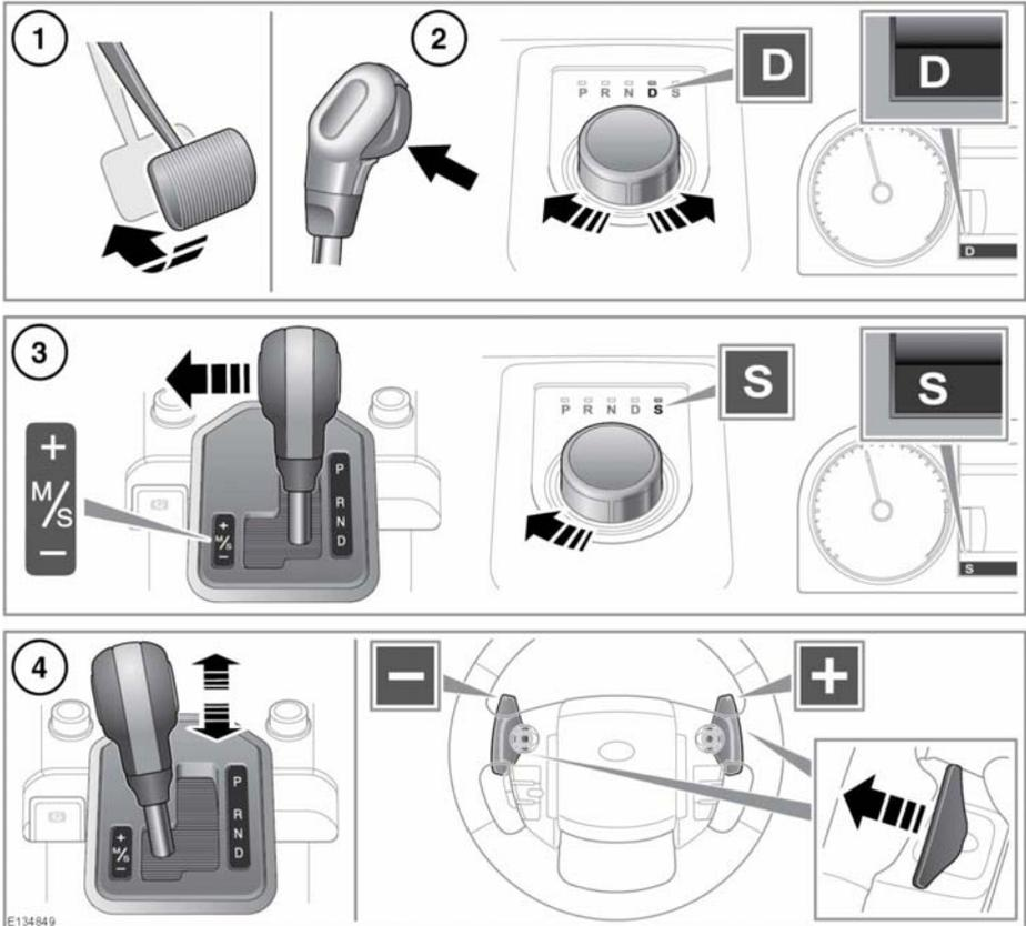
1. Vor der Auswahl der Fahrstellung (D) bei stehendem Fahrzeug zunächst die Fußbremse betätigen.
