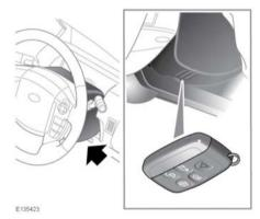
Den Smart Key so gegen die Unterseite der Lenksäulenverkleidung halten, dass die Tasten nach unten zeigen.
