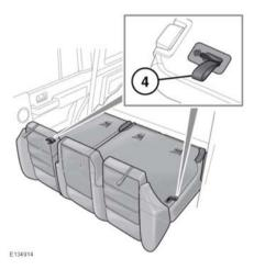
Die Schlaufe (4) nach oben ziehen, um die Sitze zu entriegeln, und zum Aufrichten der Sitze das Umklappverfahren in umgekehrter Reihenfolge durchführen.
