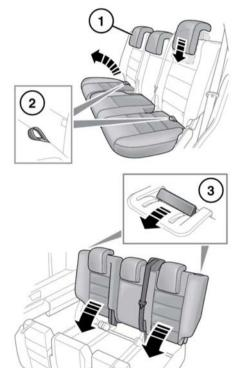
Der geteilte Rücksitz kann vollständig umgeklappt werden, um Raum für große Lasten zu schaffen. Alternativ kann nur ein Teil des Rücksitzes umgeklappt werden, so dass Fahrgäste auf dem nicht umgeklappten Rücksitz sitzen können. Teilweises oder vollständiges Umklappen des Sitzes:
