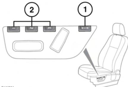
1. Zum Aktivieren der Speicherfunktion die Positionsspeichertaste (M) drücken.
