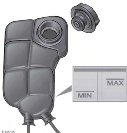
Sicherstellen, dass der Kühlmittelstand zwischen den beiden Kühlmittelstandsmarkierungen an der Seite des Ausgleichsbehälters bleibt.
