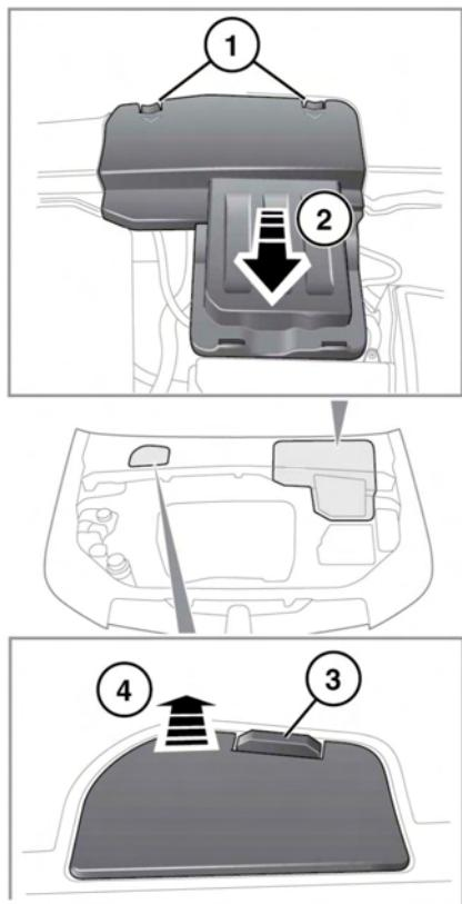
1. Gegen die Laschen drücken, um die Abdeckung vom Gehäuse zu lösen.
