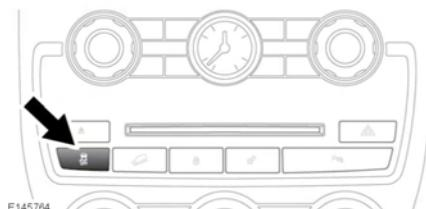
Zum Deaktivieren der DSC die Taste "DSC AUS" auf dem Armaturenbrett kurz gedrückt halten (die DSC-Warnleuchte zeigt Dauerlicht). Bei deaktiverter DSC greift auch die Traktionskontrolle nicht im normalen Umfang ein, so dass die Räder mehr durchdrehen können.
