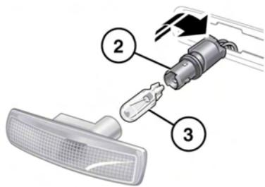
Die abgebildeten Schritte befolgen. Eine neue Glühlampe einsetzen und die Komponenten wieder einbauen.
