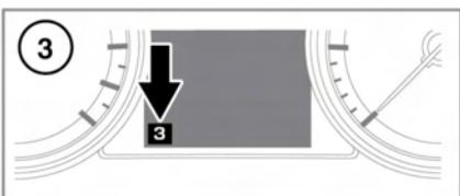
Zur Aktivierung von CommandShift™ zuerst den Sportmodus wählen, anschließend den Wählhebel nach vorn bewegen, um einen Gang hochzuschalten, und nach hinten bewegen, um einen Gang herunterzuschalten.
