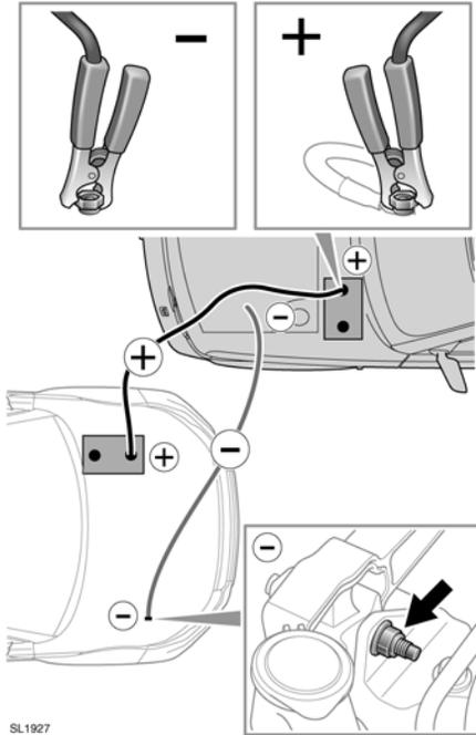
1. Das positive Starthilfekabel (rot) am Pluspol (+) der Batterie des Hilfsfahrzeugs anschließen.
