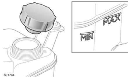
Sicherstellen, dass der Kühlmittelstand zwischen den beiden Markierungen **MIN** und **MAX** an der Seite des Ausgleichsbehälters bleibt.
