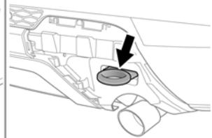
Die Abschleppösen befinden sich hinter Blenden in den Stoßfängern. Die Gestaltung der Blenden variiert in Abhängigkeit von der Fahrzeugspezifikation. Zum Verwenden der Abschleppösen:
