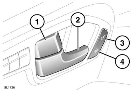
1. Zum Verriegeln einer Tür einen Verriegelungshebel drücken. Zum Entriegeln am Hebel ziehen. Die Betätigung eines der beiden Vordertür-Verriegelungshebel ver- oder entriegelt alle Türen.
