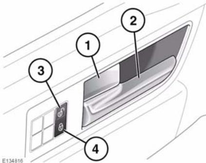
Для запираения всех дверей изнутри можно нажать рычаг блокировки (1) со стороны водителя или пассажира.
