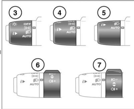
1. Bei eingeschalteten Scheinwerfern den Bedienhebel vom Lenkrad wegdrücken, um das Fernlicht einzuschalten. Die Warnleuchte in der Instrumentengruppe leuchtet auf.
