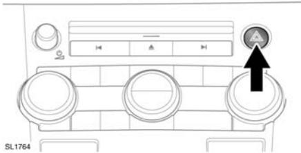
Zum Einschalten der Warnblinkanlage drücken. Zum Ausschalten erneut drücken. Ist die Warnblinkanlage eingeschaltet, blinken auch die Blinkleuchten im gleichen Rhythmus.
