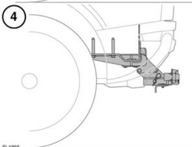
1. Am Flansch angeschraubter Anhängerkupplungs-Kugelkopf
