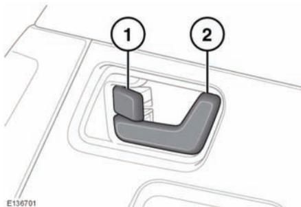
Vom Fahrgastraum aus können durch Drücken des Verriegelungshebels (1) auf der Fahrer- oder der Beifahrerseite alle Türen verriegelt werden.
