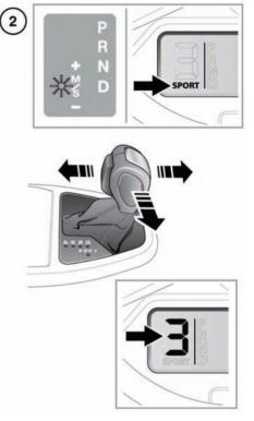
Zur Aktivierung von CommandShift™ zuerst den Sportmodus wählen, anschließend den Wählhebel nach vorn bewegen, um einen Gang hochzuschalten, und nach hinten bewegen, um einen Gang herunterzuschalten.
