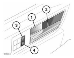
Vom Fahrgastraum aus können durch Drücken des Verriegelungshebels (1) auf der Fahrer- oder der Beifahrerseite alle Türen verriegelt werden.
