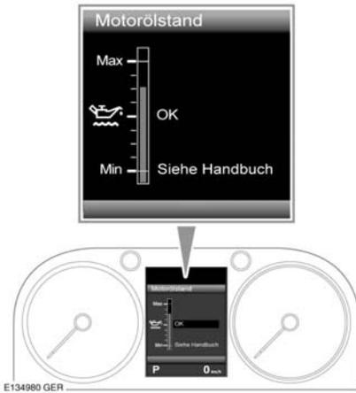
Der Ölstand wird auf der Skala angezeigt. Meldungen rechts neben der Skala weisen auf Maßnahmen hin, die durchgeführt werden müssen.
