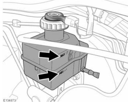
Beim Linkslenker muss die linke, beim Rechtslenker die rechte Abdeckung im Motorraum abgenommen werden (1), um den Bremsflüssigkeitsstand zu kontrollieren. Siehe Seite 201, **ABDECKUNGEN IM MOTORRAUM – AUSBAU**.
