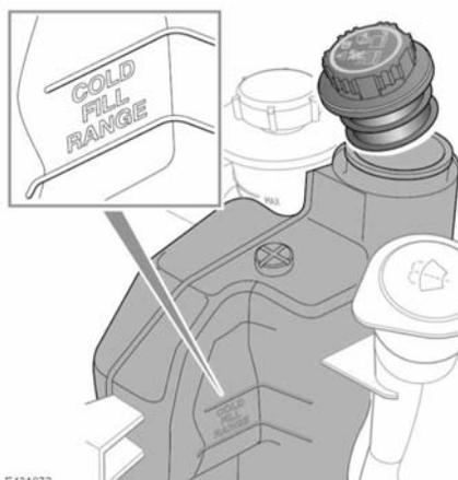
Der Kühlmittelstand muss zwischen den beiden Kühlmittelstandsmarkierungen „COLD FILL RANGE“ (Füllstand im Kaltzustand) an der Seite des Ausgleichsbehälters liegen. Kühlmittel, das im oberen Bereich des Behälters zu sehen ist, ignorieren.
