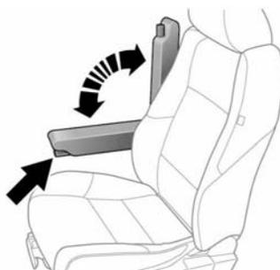
Falls vorhanden, wird die klappbare Armlehne verstaut, indem sie in die vertikale Position gebracht wird. Mit dem Einstellrad (Pfeil) die gewünschte Höhe einstellen.
