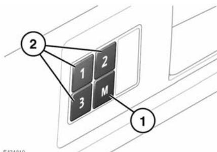
1. Zum Aktivieren der Speicherfunktion die Positionsspeichertaste (**M**) drücken.
