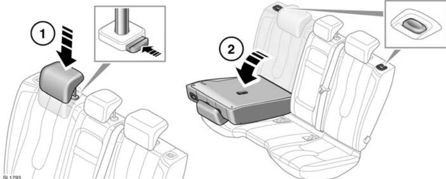
Il sedile posteriore sdoppiabile dei modelli a 5 porte può essere ripiegato completamente o parzialmente con lo sdoppiamento 60/40, per avere più spazio di carico pur continuando a disporre di posti a sedere.
