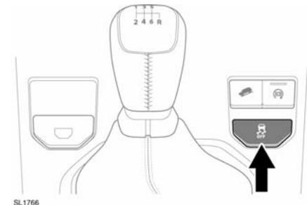
Per disattivare il DSC, tenere premuto per un breve istante l'interruttore di disattivazione del DSC. La spia di disattivazione del DSC si illuminerà di continuo. Si illuminerà anche la spia gialla di disattivazione del DSC sul gruppo strumenti. La disattivazione del DSC, inoltre, riduce il livello di intervento del controllo della trazione e può portare a un aumento del giramento a vuoto delle ruote.
