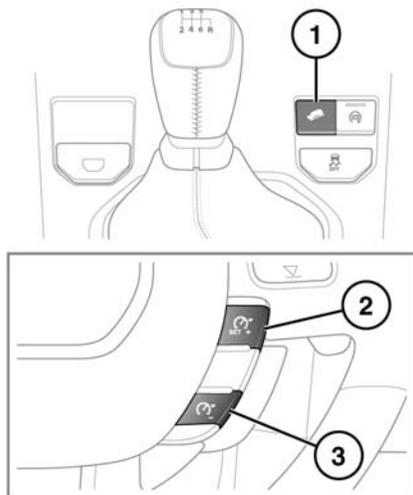
1. Premere per inserire o disinserire il controllo HDC.
