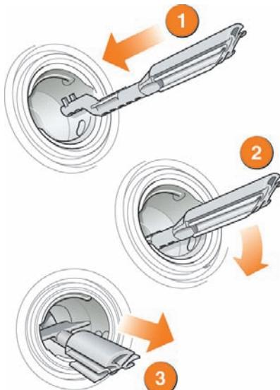
Per impedire che un serbatoio di carburante diesel venga accidentalmente rifornito di benzina, nel collo del bocchettone di rifornimento è presente un dispositivo di protezione. Il dispositivo viene attivato se viene inserito a fondo un becco di pistola erogatrice di tipo errato. Il becco della pistola erogatrice delle stazioni di rifornimento di benzina senza piombo è più stretto e determina la chiusura di una linguetta e l'interruzione del rifornimento di carburante.
