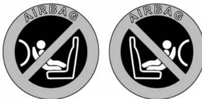
Эта наклейка на торцевой части панели приборов со стороны пассажира предупреждает о недопустимости использования кресла с расположением ребенка лицом назад на переднем пассажирском сиденье, если подушка безопасности переднего пассажира установлена и активирована.
