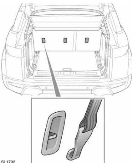
На автомобиле предусмотрены точки крепления, расположенные на задней части рам сидений второго ряда. Их следует использовать для установки лямок детских кресел или систем пассивной безопасности.
