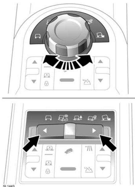
取决于具体车辆规格，可以选择全地形反馈适应系统控制按钮。
