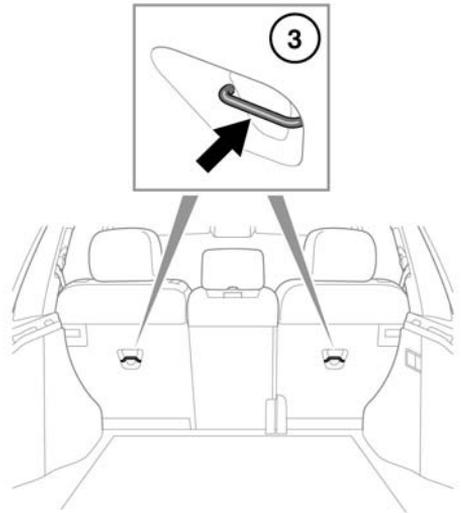
Die Sicherheit des Kinderrückhaltesystems überprüfen. Dazu versuchen, das Kinderrückhaltesystem vom Fahrzeugsitz zu ziehen und von einer Seite zur anderen zu drehen. Auch wenn das Rückhaltesystem sicher erscheint, müssen die Verankerungen sichtgeprüft werden, um eine korrekte Befestigung sicherzustellen.
