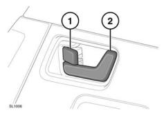
Vom Fahrgastraum aus können durch Drücken des Verriegelungshebels (1) auf der Fahrer- oder der Beifahrerseite alle Türen verriegelt werden.
