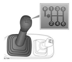
La transmission comprend une boîte de vitesses principale à six vitesses et une boîte de transfert à deux gammes (haute et basse). Un différentiel central distribue la puissance sur l'essieu avant et le pont arrière, offrant ainsi une transmission permanente à quatre roues motrices.
