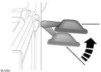
Les rétroviseurs sont conçus pour se replier sur le côté en cas d'impact. Ils peuvent également se replier pour négocier des espaces étroits.
