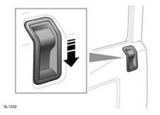
Pour déverrouiller le hayon, enfoncez le loquet de verrouillage.
