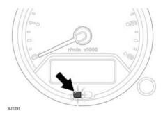
Le témoin d'alarme informe le conducteur de l'état de l'alarme. Une fois le véhicule déverrouillé, l'un des états suivants est indiqué.
